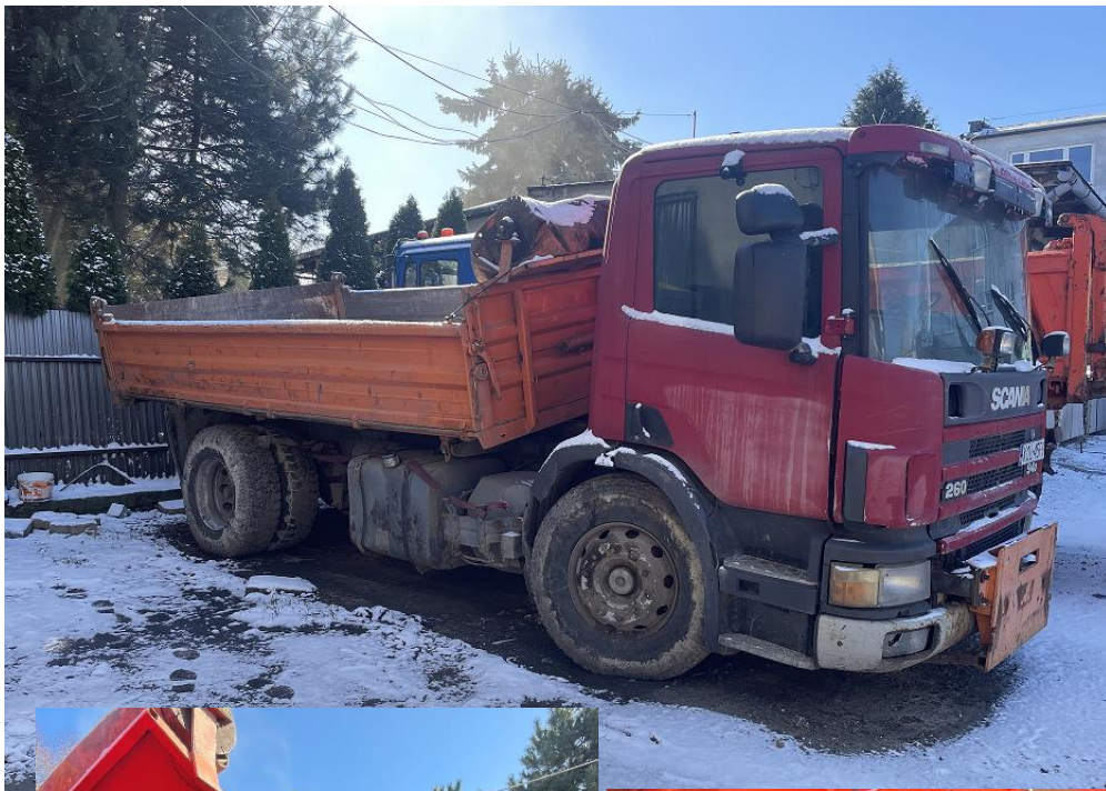
Pozycja 2, Scania (Samochód specjalny przeznaczenie do zimowego utrzymania dróg) z zabudową wywrotki MEILLER
